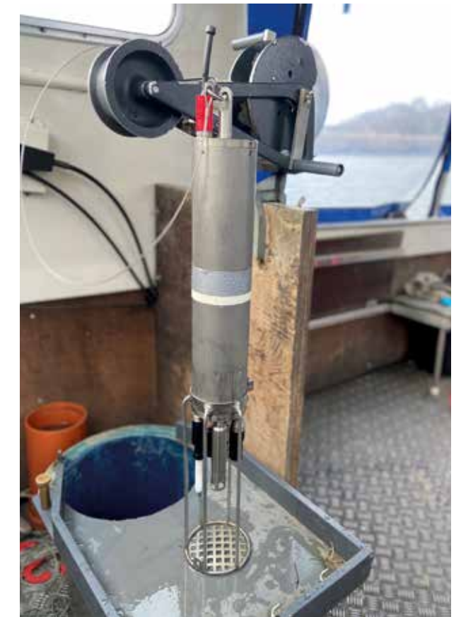
Abbildung 1 Foto der Multiparameter Sonde (Messinstrument) für die Messung der tiefenabhängigen Trübung in der Talsperre
