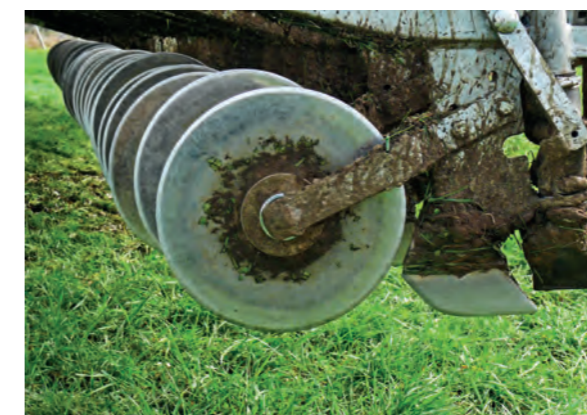
Durch die Schlitztechnik kann die Gülle emissionsarm in das Grünland ausgebracht werden
